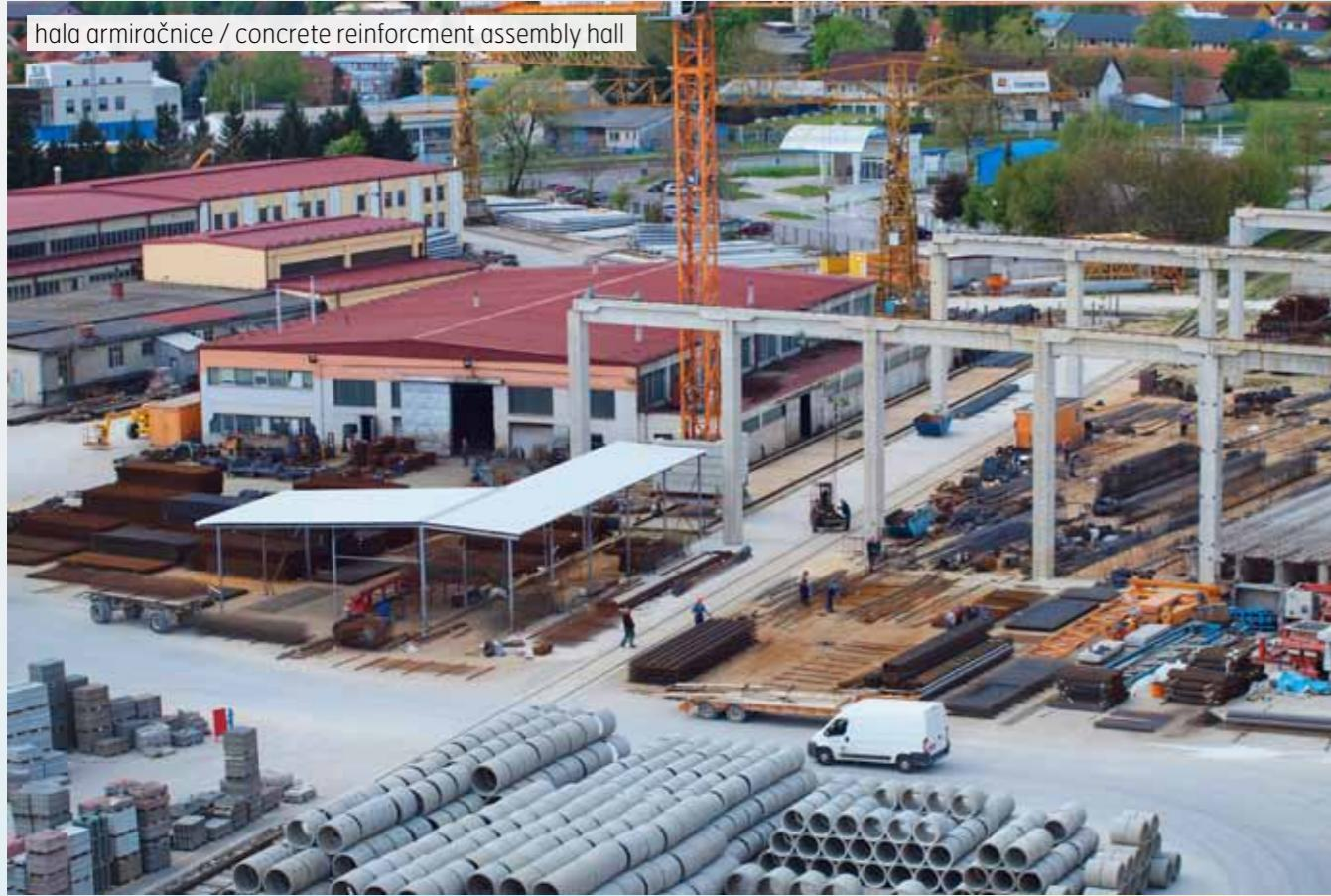
U pogonu u hali površine oko 1.200 m<sup>2</sup> postoji i armiračnica za izradu gotove armature i vezanje gotovih armaturnih koševa za potrebe proizvodnog pogona. Godišnja je proizvodnja armiračnice 18.000 tona, od čega za potrebe proizvodnog pogona 10.000 tona, a ostatak za gradilišta i za kupce.
